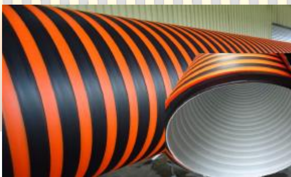
HDPE 纏繞污水管 內白外黑加橘色警示條
